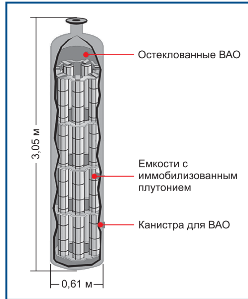
Рис. 1.126. Технология захоронения «can-in-canister»
