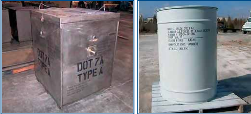
Рис.1.127. Примеры использования свинца в качестве экранирующего материала при изготовлении контейнеров и канистр для нужд DOE
